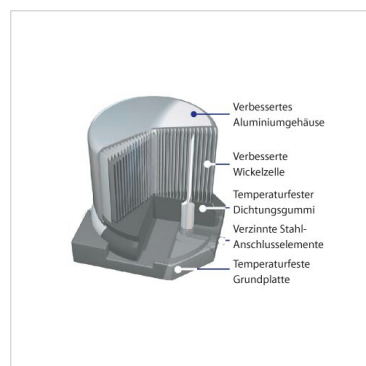
Bild 2. Ein sinnvoller Ansatz, um den Folgen des siedenden Elektrolyten entgegenzuwirken, besteht darin, die Kondensatorkonstruktion zu verstärken und bestimmte Materialien zu verbessern. Dazu zählen primär das Gehäuse und die Abdichtung.
